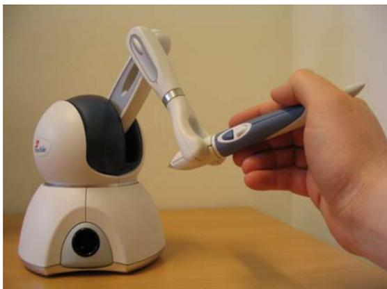
Abb. 1: Krafrückkopplungsgerät PHANTOM Omni der Firma SensAble
